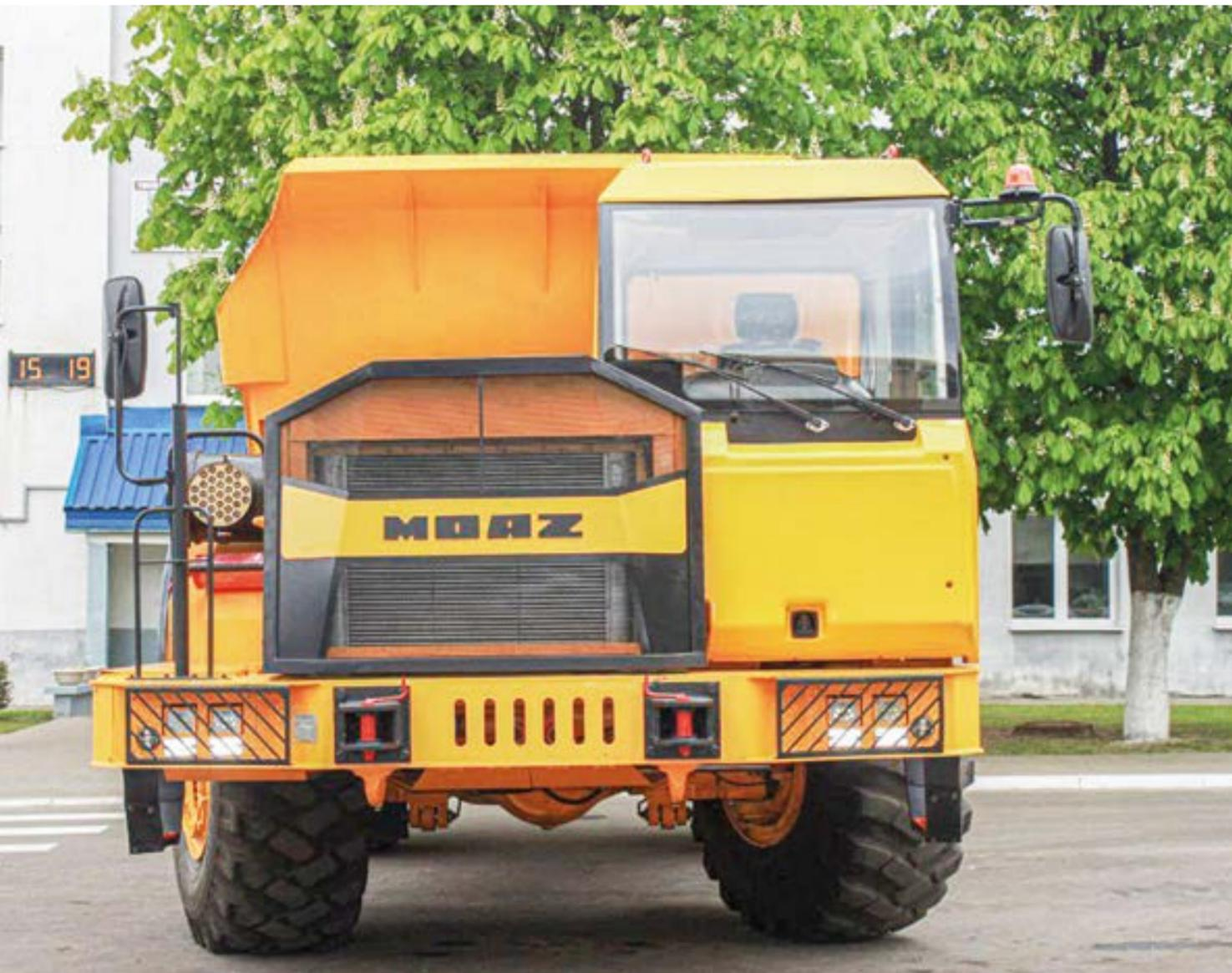
МоАЗ-75053 грузоподъемностью 25 тонн оснащен 380-сильным дизельным двигателем китайского производства и жесткой высокопрочной рамой и предназначен для перевозки насыпных грузов как по технологическим дорогам, так и по бездорожью в горнодобывающей и строительной отраслях. Этот внедорожник пришел на смену самосвалу-землевозу МоАЗ-75050, превзойдя предшественника в надежности, выносливости и комфортности.
