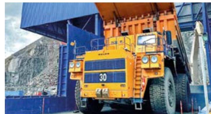
27 САМОСВАЛОВ БЕЛАЗ ГРУЗОПОДЪЕМНОСТЬЮ 240 ТОНН ПРИСТУПИЛИ К ДОБЫЧЕ ЖЕЛЕЗНОЙ РУДЫ В КАРЕЛИИ
